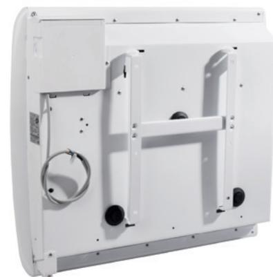
Support de fixation métallique. Simple à fixer, le support est utilisé comme gabarit de pose pour percer les 4 trous d'accroches du produit. Présence d'un système de verrouillage évitant le décrochage accidentel du produit.
