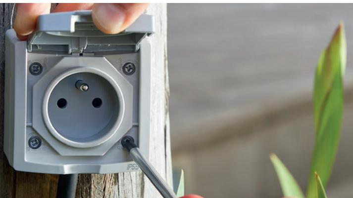
Gamme étanche d'usage général. Installation en saillie pour intérieur et extérieur. Indice d'étanchéité IP54 et IP44 pour la prise afin de résister aux aléas des conditions climatiques. Entrées de câble en diamètre max 20mm. Membranes flexibles. 7 commandes d'éclairage et prises disponibles, en connexion à vis
